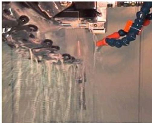
Las posibles virutas adheridas de mecanizado al cono y a la nariz del husillo, son eliminadas mediante limpieza a presión de refrigerante durante el cambio de herramientas.
